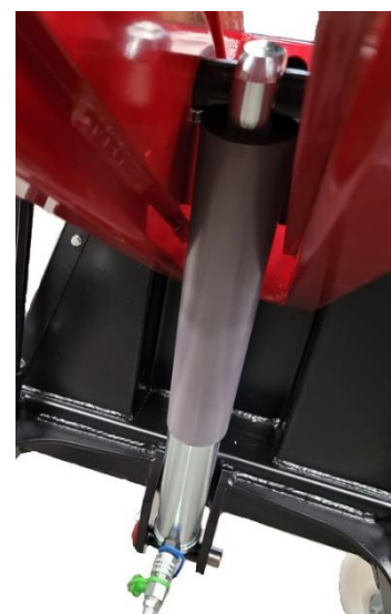
Lyftkolvsskydd för att skydda kolven från slag och smuts.
